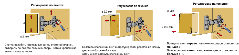
Рис.2 Схема установки петель
