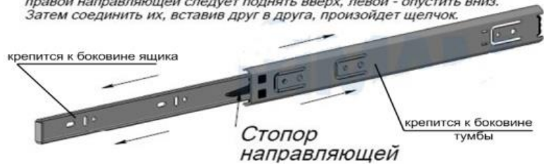
Рис.3 Схема установки шариковых направляющих
