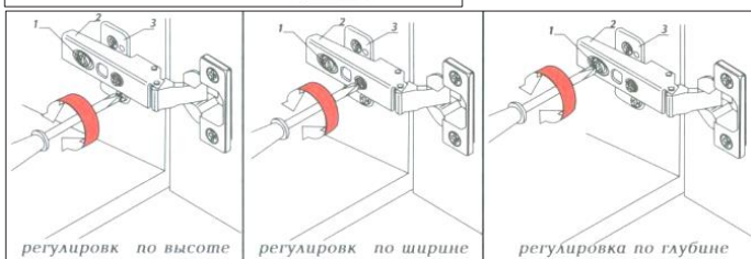
Рис. 3 Регулировка петель
